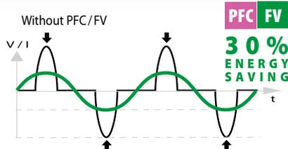
De última generación, el GYSMI 200E FV dispone de un PFC de gran envergadura, lo que le convierte en FLEXIBLE VOLTAGE (85-265V).
